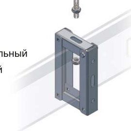
Монтаж к потолку
