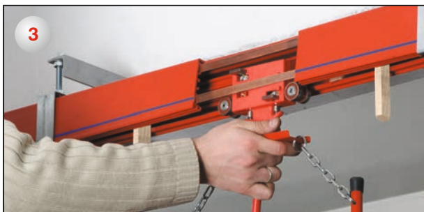
3 Сместите проводники вручную и снимите токосъемник из положения, в котором он установлен.
