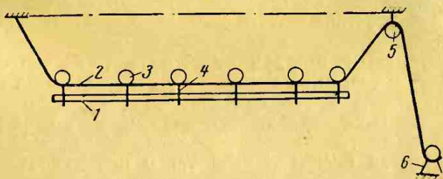
Рис. 27. Подъем блоков магистральных шинопроводов способом развернутого полиспаста.
