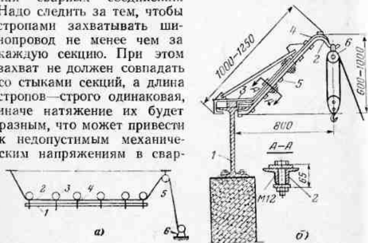
Рис. 31. Подъем блоков магистральных шинопроводов без применения кранов.
